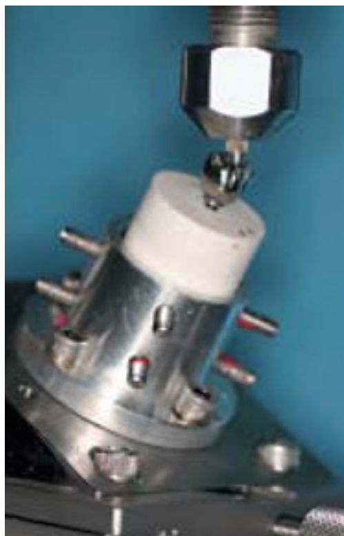
Montaje para la prueba mecánica
